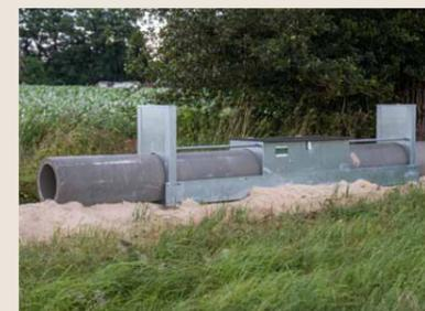
Bei der Falle von Fallenfuchs handelt es sich um eine optimierte Wipprohrfalle. Das Mittelrohr fungiert als Wippe und liegt in einer kugelgelagerten Wanne. Das Auslösegewicht lässt sich stufenlos ohne Werkzeug einstellen. Die Auslösung ist dadurch sehr präzise und steht wie ein guter Abzug absolut trocken. Nach dem Auslösen wird die Wippe automatisch zu der Seite blockiert, von der
