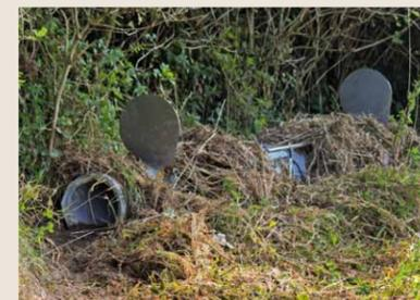
Tuscher's Betonrohrfalle gibt es als Modell für 25er und für 30er Betonrohre. Sie löst über zwei innenliegende Tritte aus Metall aus, die ca. 30 cm links und rechts der Fallenmitte liegen. Die Fallenklappen sind federgelagert und nicht in einem Kasten verbaut. Dadurch sind sie nicht geschützt, was zu Funktionsstörungen durch herabfallende Äste, Schnee o.Ä. führen kann. Die reibungslose Funktion
