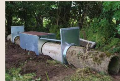
Das neue Modell von Fallenbau Dose ist von der Funktion und dem Aufbau fast identisch mit dem alten Modell des Herstellers. Heißt, die Falle besteht auch aus fünf Betonrohren, wobei das mittlere Rohr auf einer Wippe steht. Links und rechts des Wipprohrs befindet sich je ein weiteres Rohr. An diese schlie-
