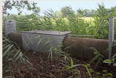
Die Ammerländer Wipprohrfalle wird von der Firma Grimm Maschinenbau produziert, die ihren Schwerpunkt nicht im Fallenbau hat. Das Wipprohr steht auf einer Wippe in einer Umbauung aus verzinktem Material. Die schwach dimensionierten Schieber werden nicht wie bei allen anderen Modellen durch ein Gestänge gehalten, sondern durch Stahlseile, die durch ein Rohr geführt werden.
