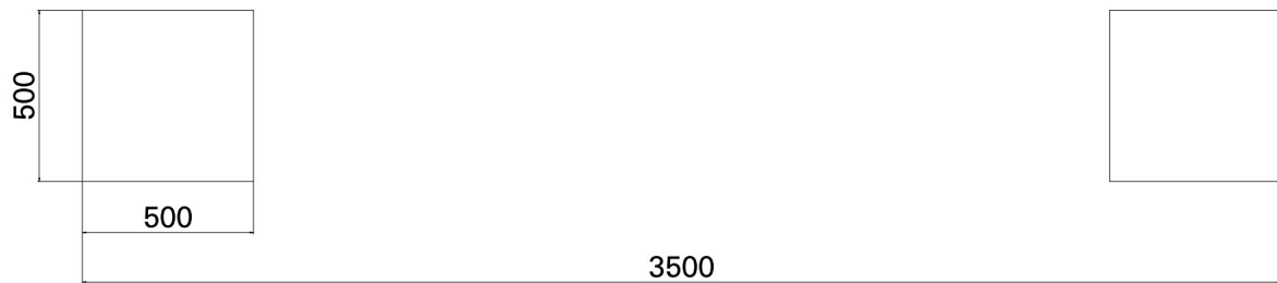
Abb. 3: Verlegung Betonplatten, Maße in Millimetern angegeben
